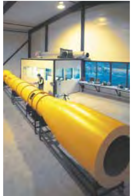
Bildet viser JLB viftelab. for kapasitet- og lydmåling.
