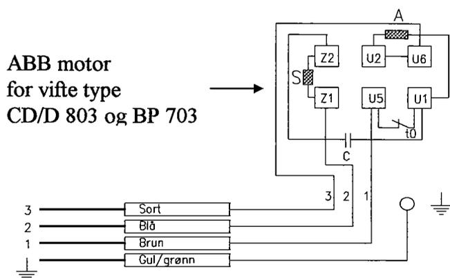
Vifter som er påmontert ledning fra fabrikk har ledere med farger og kobling som vist på koblingsskjema over. For kobling med 3 leder benyttes 1, 2 og 3. Med 2 leder kobles leder 2 og 3 sammen.
