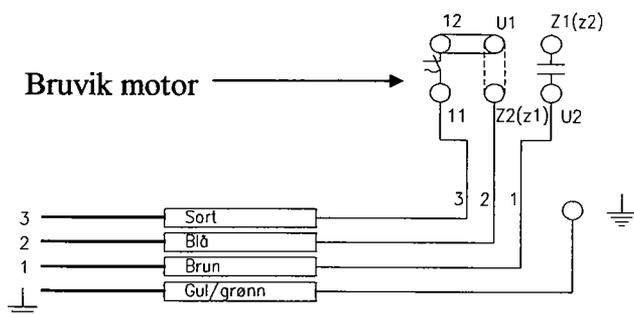
Skinne mellom U1 og Z2 er fjernet på Bruvik motorer, når ledninger er montert.
